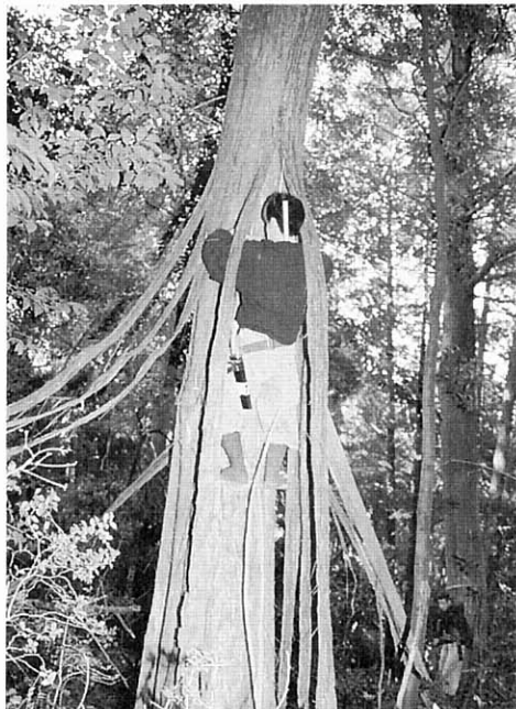
ロープで足場を作り、自作の木製ヘラを使って上へ上へと丁寧に檜皮をはいていく
