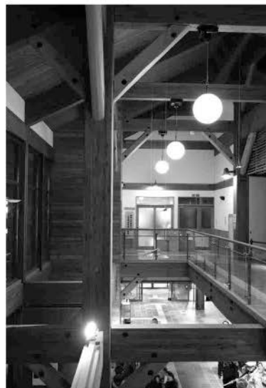
上高地インフォメーションセンター。 蓄熱床暖房を利用した暖かい吹き抜け空間
